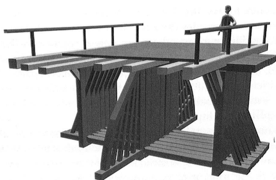
Fig. 18. Carouge GE, pont du 12 e s. Reconstitution 3D de la pile de pont, avec renfort longitudinal dans l'axe central. Vue sur le tablier. Dessin SCA GE, M. Berti.
