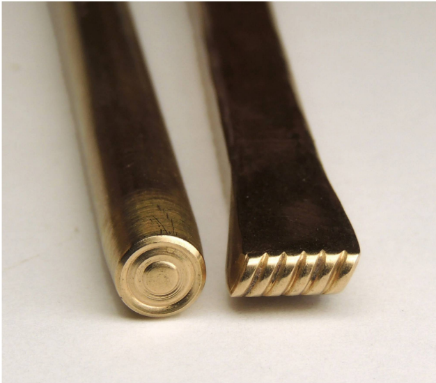
Abb. 10. Cham-Oberwil ZG «Äbnetwald». Grab Pos. 400. Die zwei für die Versuche verwendeten Bronzepunzen. Foto ADA, M. Binggeli.
