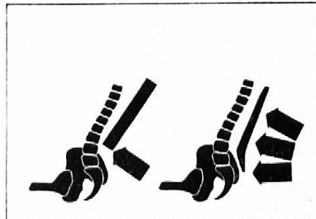
Die Wirbelsäulenform wird massgeblich durch die Stellung des Beckens bestimmt. Die neue Rückenlehne beeinflusst direkt die Beckenstellung durch Abstützung der Kreuz- und Lendengegend. Unangenehme Druckpunkte werden vermieden.
