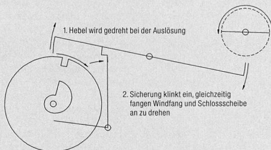
Fig. 11. Auslöse- und Stoppmechanismus, Stellung kurz nach Auslösung.
