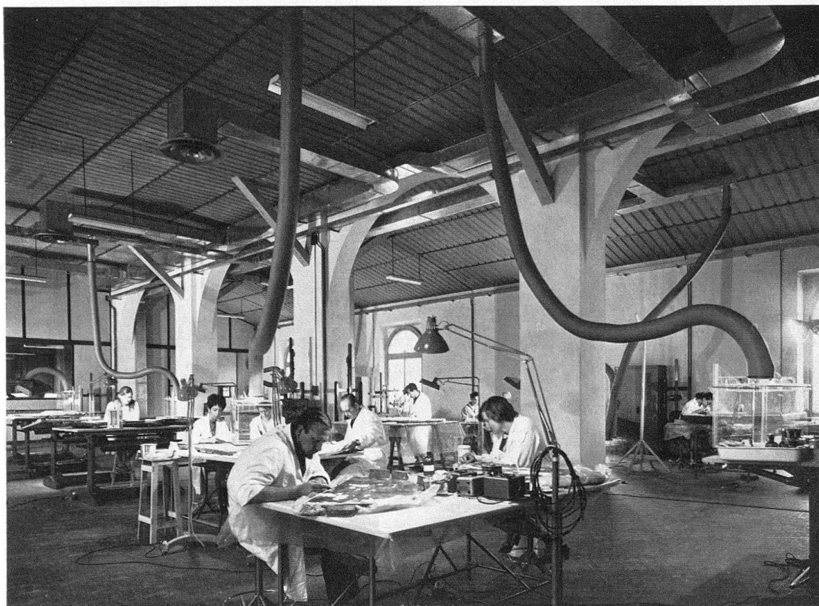
Eines der neuengerichteten Restaurierungsateliers in der Fortezza di Basso in Florenz. Deutlich sichtbar sind die Absaugvorrichtungen über jedem Arbeitsplatz; sie ermöglichen das Arbeiten mit den teilweise giftigen Lösemitteln
