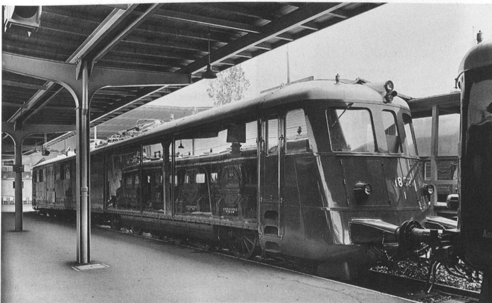
7 Die «Landi»-Lokomotive mit durchsichtigen Seitenwänden. – An der Ausstellung waren die Seitenteile auf einer Seite mit Glasscheiben ersetzt worden. Dies erlaubte einen Blick in den imposanten Maschinenraum mit den je zwei Motoren für die insgesamt 8 Antriebsachsen.
