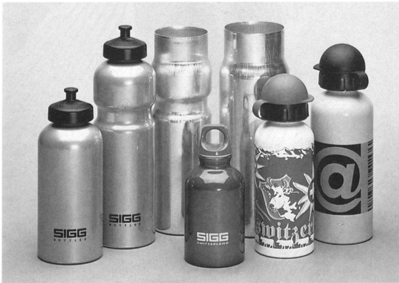
8 Sigg-Bottles von 1997. – Die Outdoor-Produkte, insbesondere die Bottles, gehören zu den wenigen Küchenartikeln, die heute noch aus Aluminium hergestellt werden: Bett- und Getränkeflaschen (vorne mitte) und Sportbottles (links und rechts) entstehen in wenigen Arbeitsschritten aus demselben fließgepressten Reinaluminiumbutzen (hinten).
