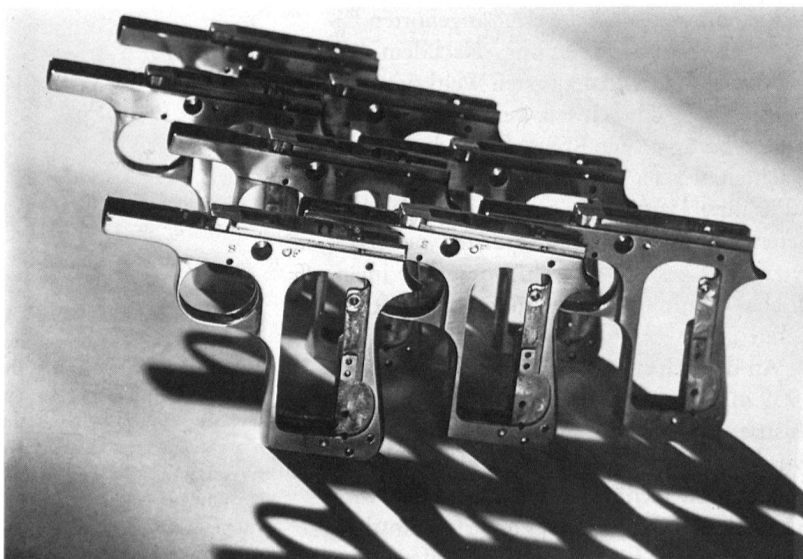
3 Gussteile für die Militärpistole «Beretta» aus der Produktion von 1934. – Militäraufträge bildeten schon immer ein wichtiges Absatzgebiet der Aluminiumindustrie.
