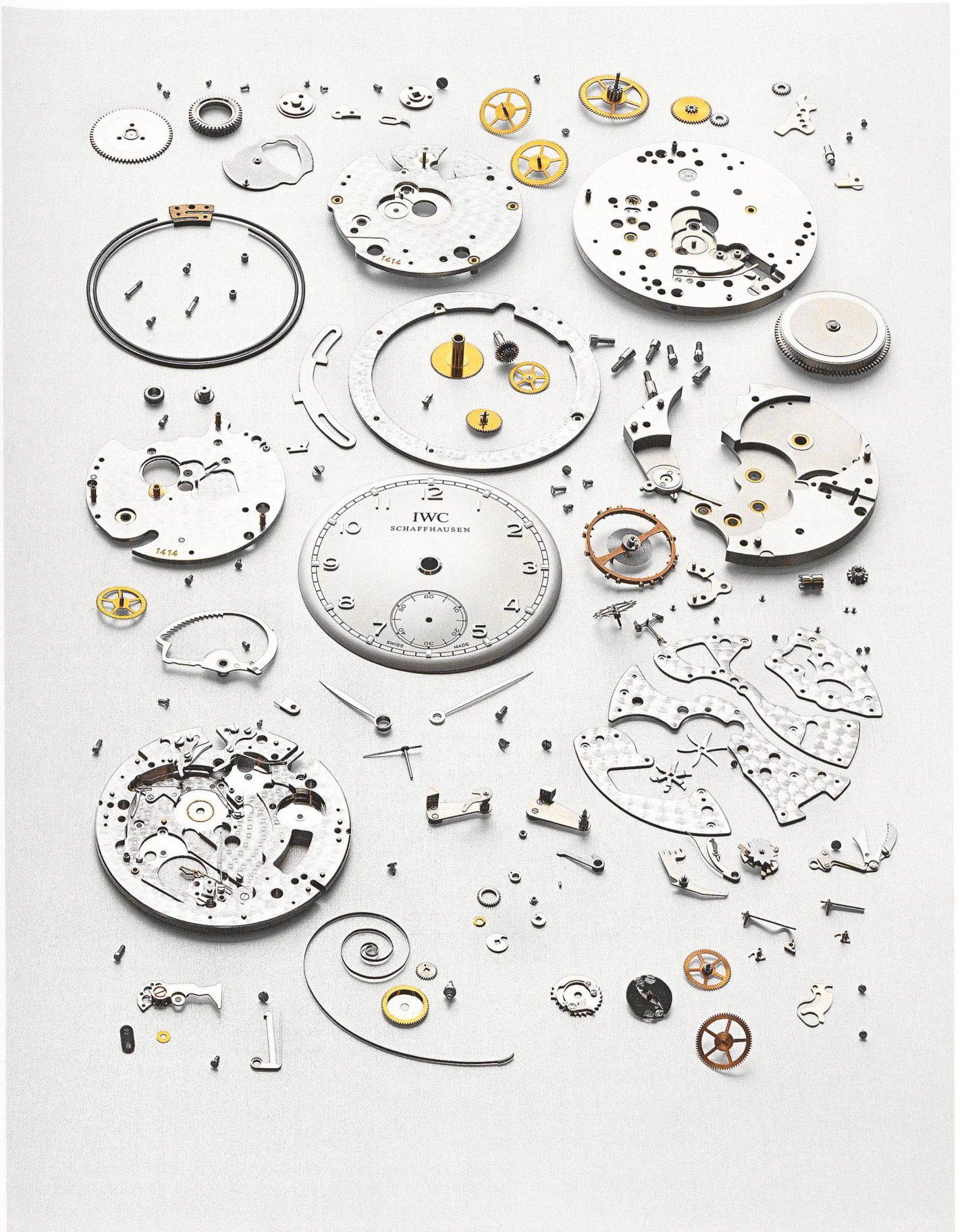
Uhrmacherkunstwerk: die Teile einer «Portugieser Minutenrepetition»
