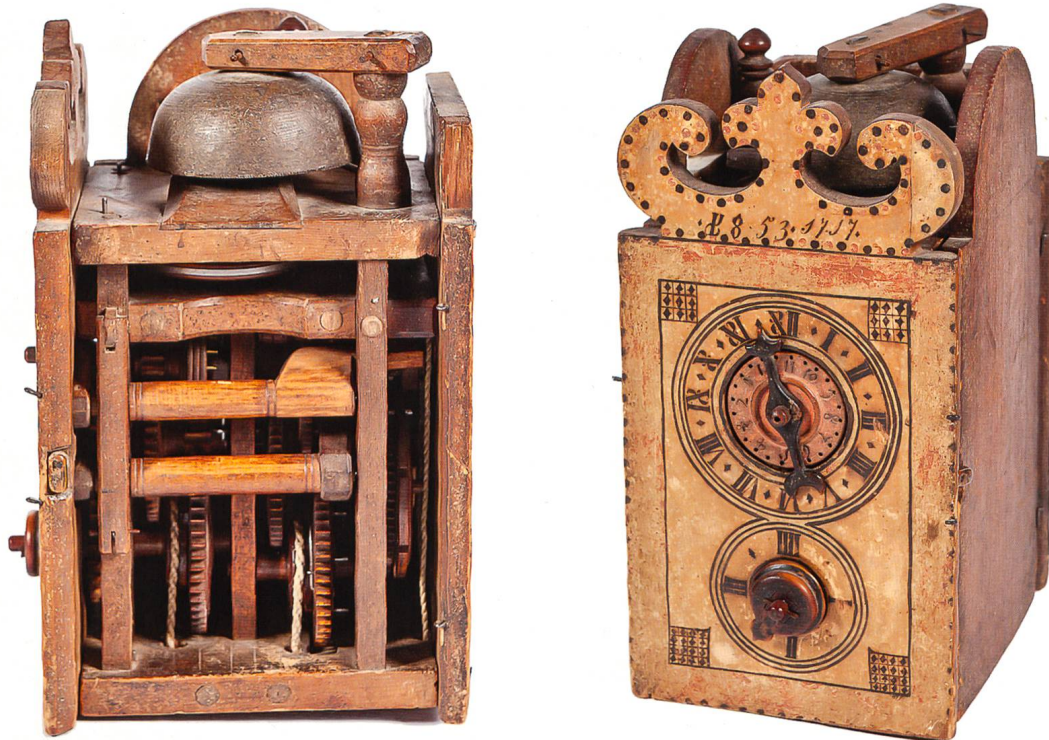
Davoser Holzrädenuhr. Sertigtal, 1717. Gehwerk mit Radunruhe, Stundenschlagwerk, Wecker. Inv.383. Der Stundenzeiger ist aus einem Stück geschnitzt und wie bei den frühen Eisenuhren auf das Stundenrad aufgesetzt, das zugleich Weckerscheibe mit 12 oder 24 Einstecklöchern ist. Das massive Werkgestell ist in Pfeilerbauweise mit drei Werkplatten gebaut. Meistens sind die obere und die untere Werkplatte aus Arvenholz. Die Pfeiler sind aus Lärchenholz und die Räder und die Platinen aus einheimischer Bergbirke. Die Räder der Gaschurner Uhr sind dreieckverzahnt und die Volltriebe aus Holz geschnitzt. Es mag erstaunen, aber die allermeisten Räder laufen auch nach gut 300 Jahren immer noch rund und flach, obwohl sie nicht aufgeleimt, sondern nur mit zwei Holzstiften auf der Achse befestigt sind. Fotos Michael Peuckert
