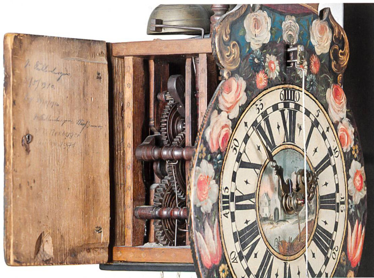
Appenzeller Holzräderuhr. Appenzell, 1768. Sign. 17 Joseph Guttman 68. Gehwerk mit Spindelgang, 4-Viertel- und Stundenschlagwerk. Inv. 3. Ein Merkmal im Werk einfacher Uhren von Guttman lässt doch eher auf den Uhrmacher schliessen. Diese haben eine Eigenheit am Hebel, der die Hammerwelle für das Schlagen bedient, die als «Guttman-Haarnadel» bezeichnet wird. Foto Michael Peuckert
