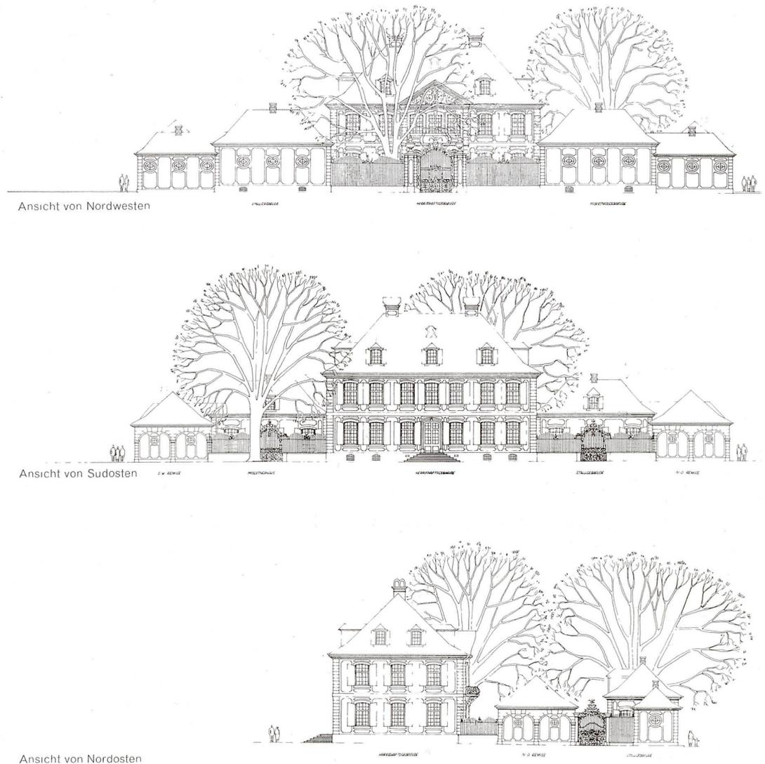
**Abb. 2** Basel, Sandgrube. Die Bauaufnahme lässt die Hauptfassade und den Vorplatz mit seinen verschiedenen, symmetrisch rahmenden Pavillons gut erkennen. © Paul Leonhard Ganz, *Die Sandgrube*, Basel 1961
