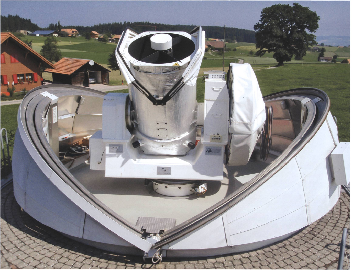
Fig.6 Télescope ZIMLAT de 1 m, à monture alt-azimutale. La coupole, constituée d'éléments concentriques, s'ouvre jusqu'à 30° de l'horizon. Le télescope est fermé par des clapets à ouverture latérale. Tous les mouvements sont pilotés par ordinateur. Photo AIUB Zimmerwald Astronomical Institute, 2010
