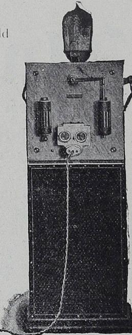
Der Quecksilberdampf-Gleichrichter Cooper Hewitt dient dazu, Wechselstrom in Gleichstrom umzuformen. Kostspielige Bedienung u. Unterhalt wie bei den rotierenden Umformern fallen dahin!
