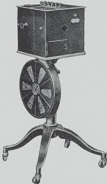
Die Billet-Druckmaschine „National“ ist hervorgegangen aus dem dringenden Bedürfnis nach einer Maschine, welche die Selbsterstellung von Billets und die Sicherung der aus dem Verkauf dieser Billets vereinnahmten Beiträge ermöglicht.
