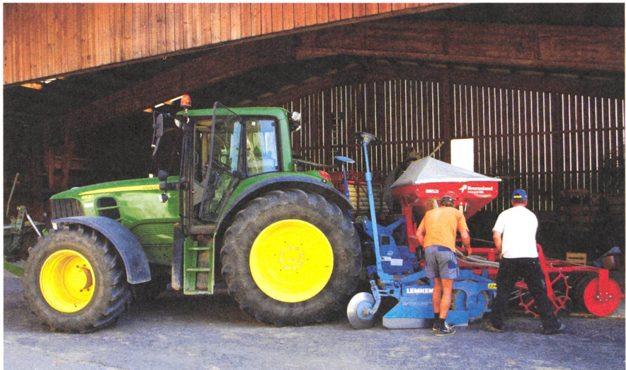
Mit dem «Jonny»: Eggen, Walzen, Säen und nochmals Walzen in einem Arbeitsgang.
