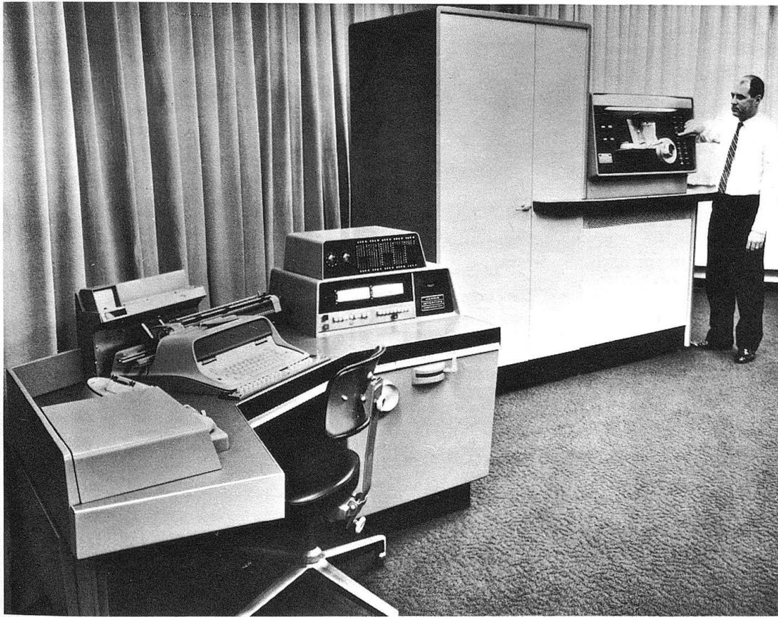
Intertype Fototronic: Steuerpult (links), elektronische Zählleinheit zur Ermittlung der Wortzwischenräume und Vornahme der Trennungen (Mitte) und Belichtungseinheit (rechts).
