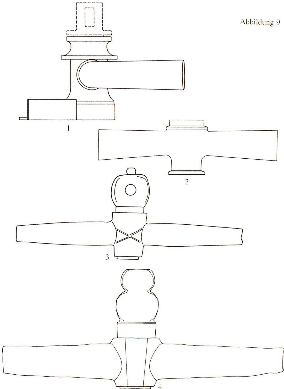
Vergleich von Röhren-Anschlüssen an Körpern (Gehäusen): einerseits bei römischen Armaturen, andererseits bei mittelalterlichen Abstellhähnen.
