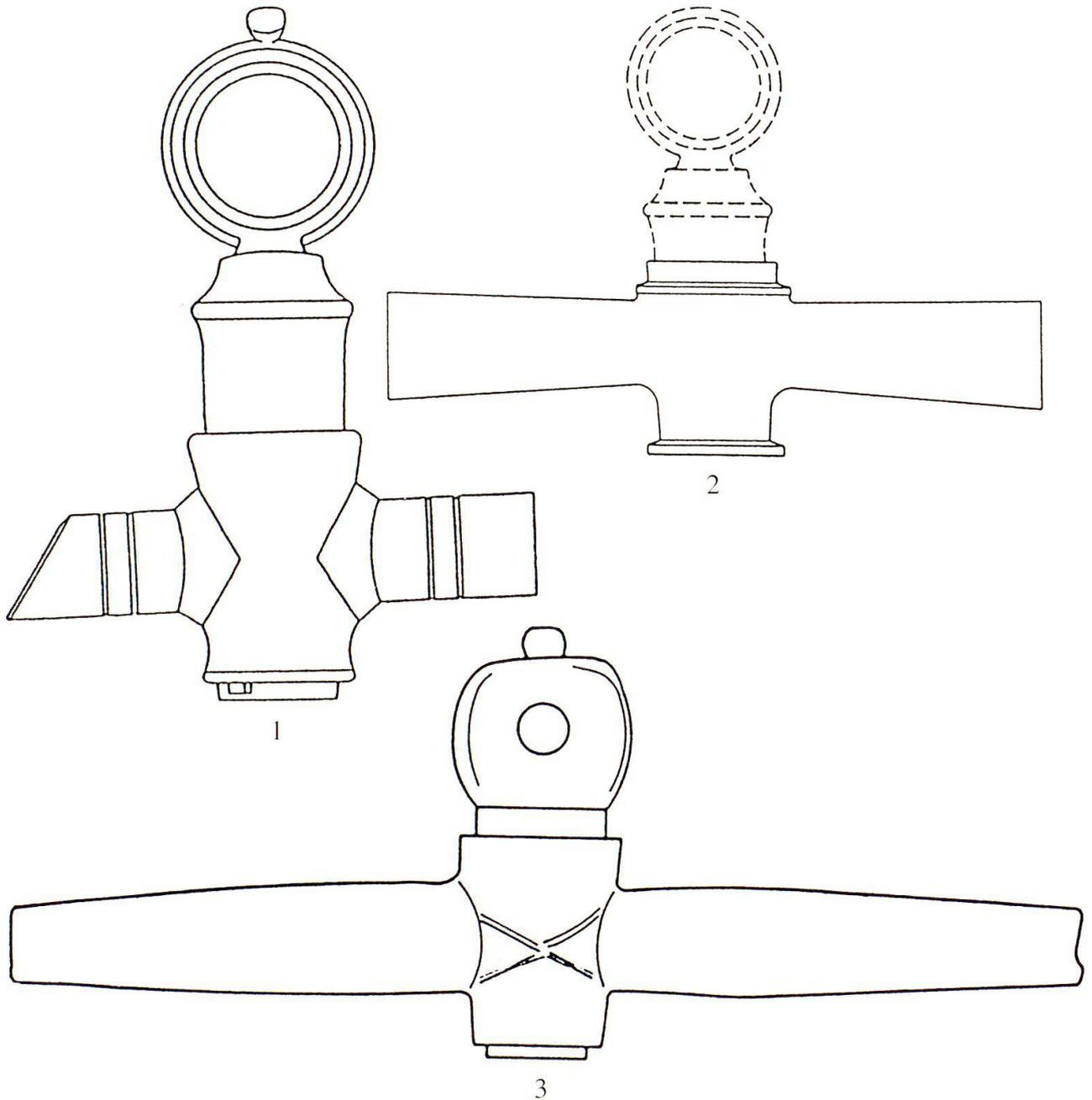
Gegenüberstellung des «aussergewöhnlichen Römerhahns» Kretzschmers mit dem massiven Vertibulum (Drehküken) mit Ring-Griff (1) und der spätantiken Abstell-Armatur aus dem Baptisterium von Riva San Vitale TI (2) mit dem nach Fig. 1 ergänzten massiven Vertibulum mit Ring-Griff.
