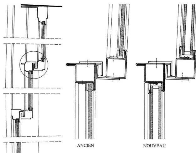
La première variante “économise” l’étude de nouveaux détails et peut miser sur la performance de tel ou tel produit. Mais le risque est bel et bien l’inadéquation de ce produit à l’ensemble de la construction : il n’y a actuellement aucune condensation en hiver car cette façade n’est pas étanche à l’air<sup>9</sup>.
