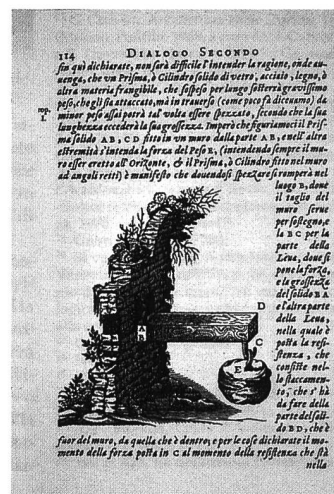
Galileo Galilei, dessin d'une poutre avec une extrémité libre et l'autre encastree dans un mur (G. Galilei, Discorsi e dimostrazioni matematiche intorno à due nuove scienze attenenti alla Mecanica e i movimenti locali, Leida, 1638, p. 114).
