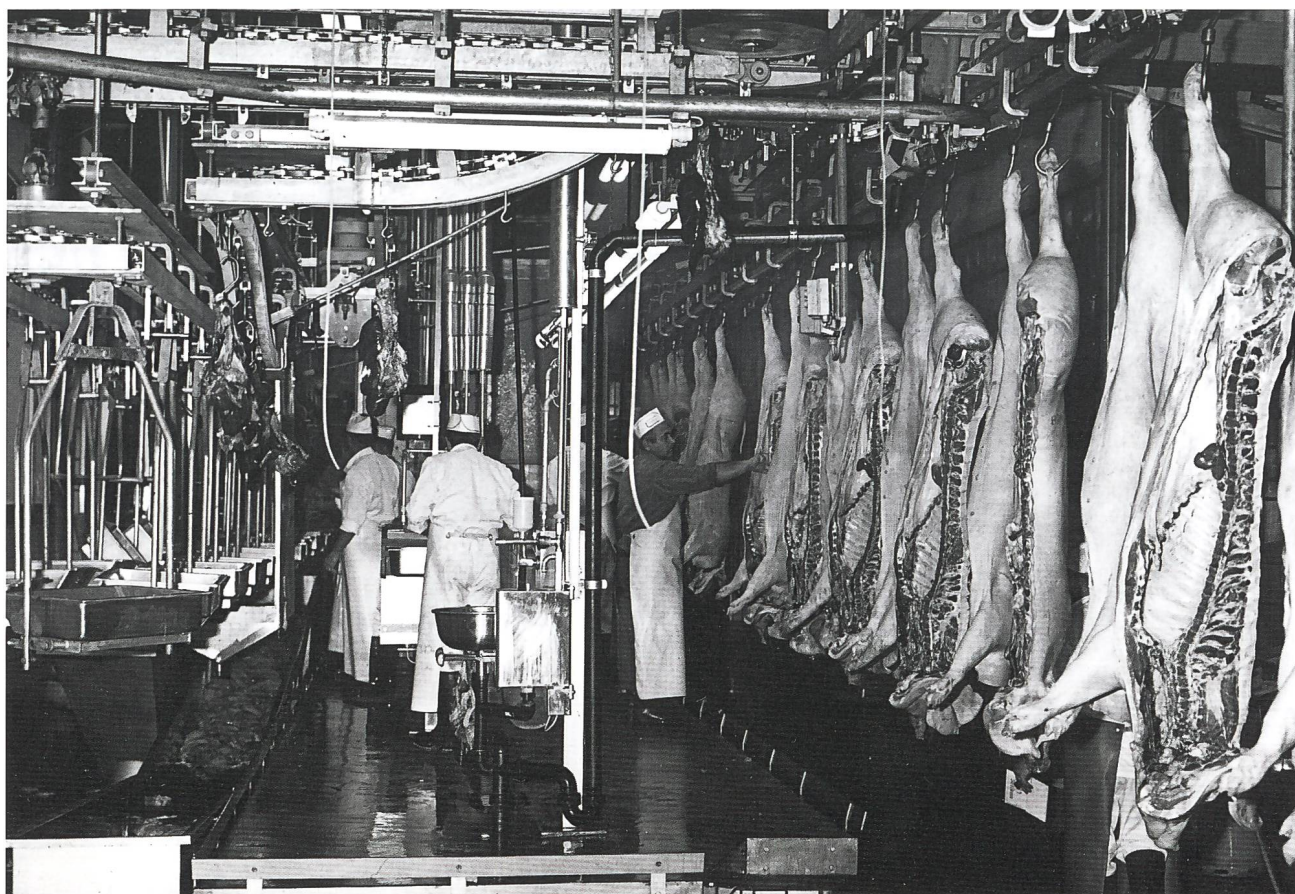
Schlachthof Zürich, Neubau 1985, mechanische Schlachtstrasse für Schweine mit Blick auf die ungeteilte Fleischschau. Links das synchron laufende Transportband mit hängenden Kippschalen für die Innereien. Das Personal steht auf Podesten.
