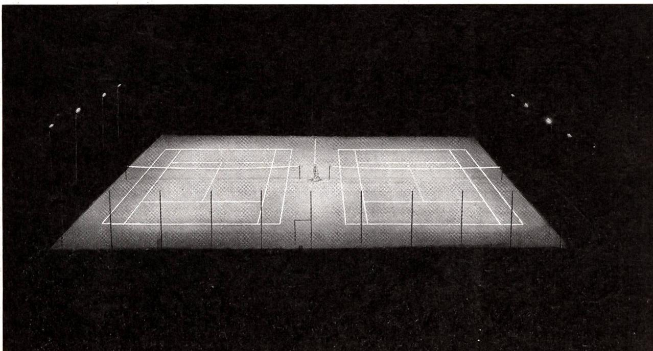
Place à deux terrains illuminée. La disposition latérale des projecteurs spéciaux avec lamelles anti-éblouissantes permet un jeu agréable. La lumière n'éclaire que la surface de jeu; ainsi, les sources lumineuses sont exploitées au maximum.
