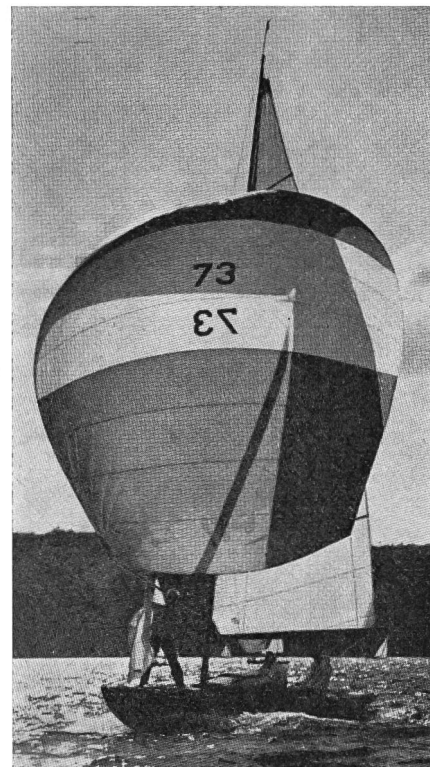
Fig. 2. Il vento soffia in poppa e sposta l'imbarcazione in avanti. Esso gonfia la vela colorata «a pallone», chiamata spinnaker . La grande, triangolare vela principale è fissata davanti al bompresso e sotto l' albero maestro , che sono o di legno o d'alluminio. Sulla randa stanno i segni indicanti la classe, il numero e, spesso, la nazionalità dell'imbarcazione. Per quelle svizzere si tratta, in quest'ultimo caso, della lettera Z. Davanti al bompresso viene fissata una piccola vela anteriore, il cosiddetto fiocco , che, su rotte speciali, può essere ammainata, come in questa figura 2, perchè non ha nessun influsso.
