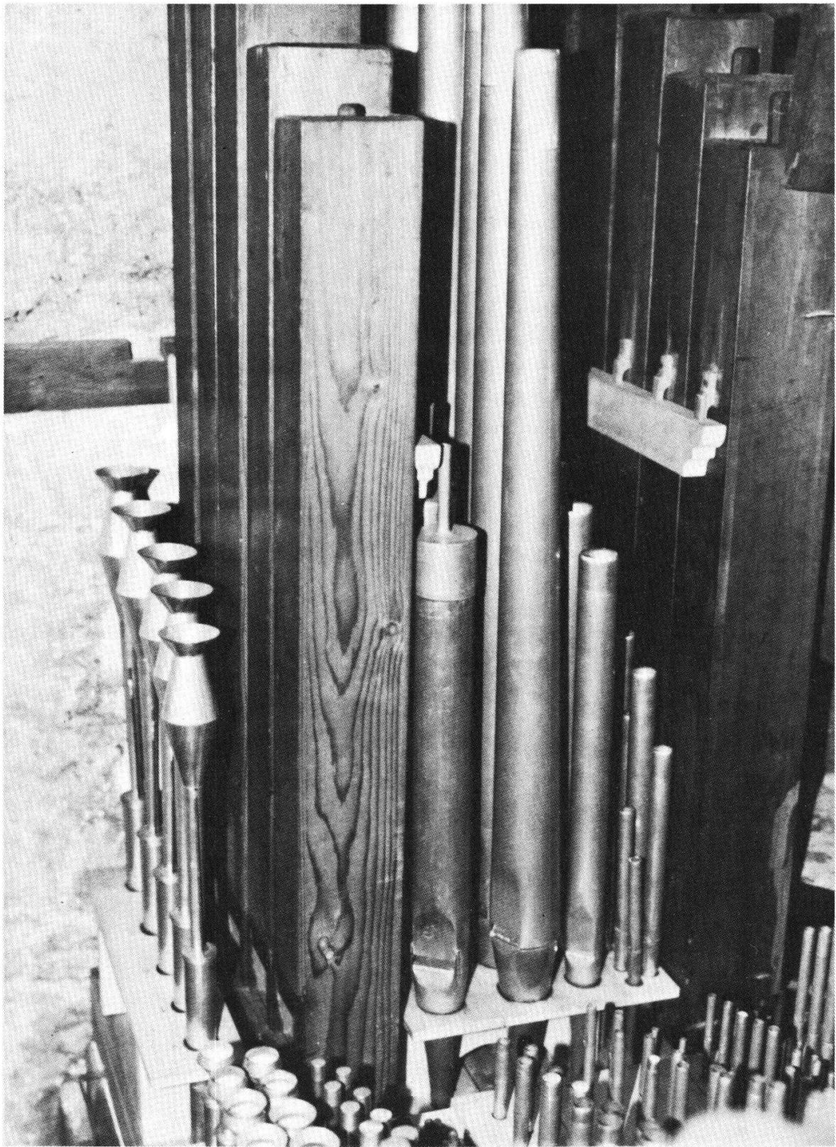
*Abbildung 2.* Die von Kiene gebaute Basslade des Positivs. Mit Ausnahme des rekonstruierten Registers «Fagot-Vox humana» ist das originale Pfeifenmaterial von Bossart und Kiene sichtbar.
