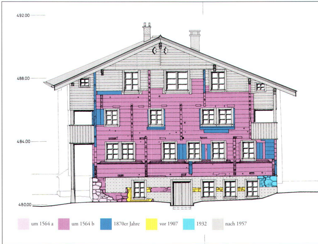
Abb. 17: Südfassade, die ursprünglichen Bauteile sind violett angelegt.
