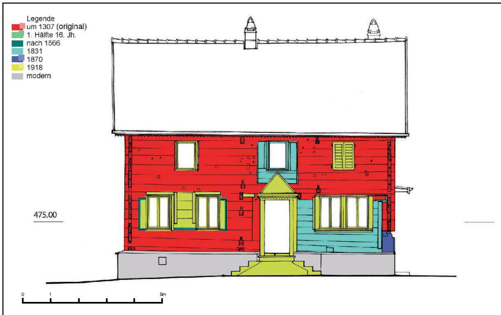
Abb. 11: Nordfassade, die ursprünglichen Bauteile sind rot angelegt.
