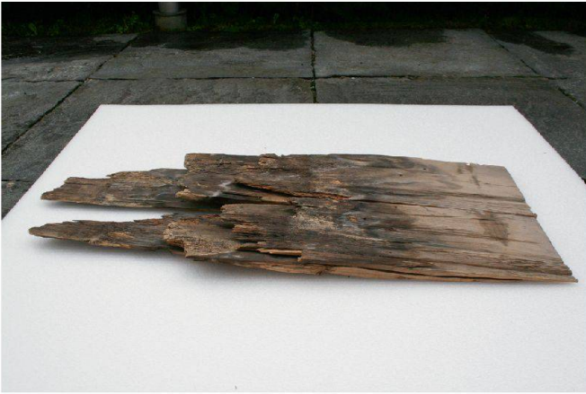
Abb. 16: Im Zuge der Renovierung der Muotathaler Pfarrkirche St. Sigismund und Walpurga im Jahr 2003 wurden Dachschildeln aus Fichtenholz (ca. 55cm x 20cm), sogenannte Spaltschildeln, geborgen, die noch aus der Bauzeit um 1780 stammen. Die Lebensdauer von Dachschildeln wird je nach klimatischen Bedingungen auf über 50 Jahre geschätzt. Eine Dacherneuerung war sehr aufwändig, daher mussten Schindeldächer bei vielen Alphütten im 20. Jahrhundert Blechdächern weichen.
