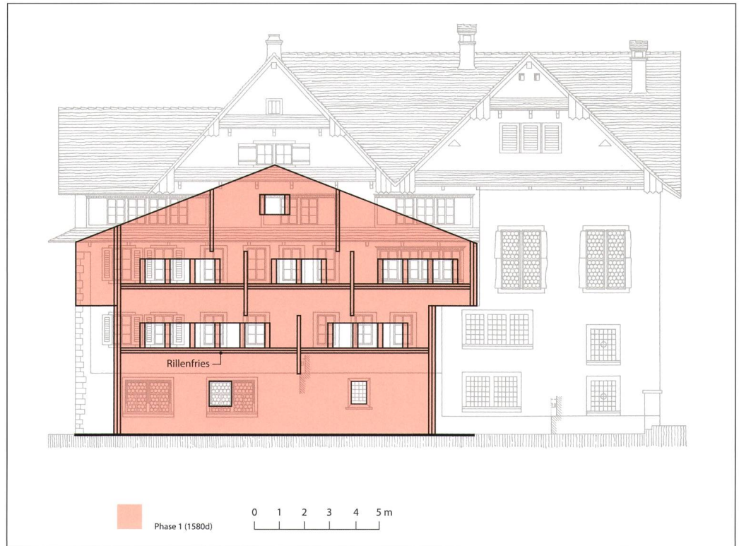
Abb. 3: Rekonstruktionsvorschlag des ersten Baus, 1580 dendrodatiert. Die Grösse des Dachraumes und die Existenz einer Dachkammer, die westliche Laube und der Rillenfries sind in Analogie zu zeitgleichen Blockbauten rekonstruiert. Die überkragende Kammer im Osten des Baus ersetzt die zuvor übliche Laube an dieser Stelle.
