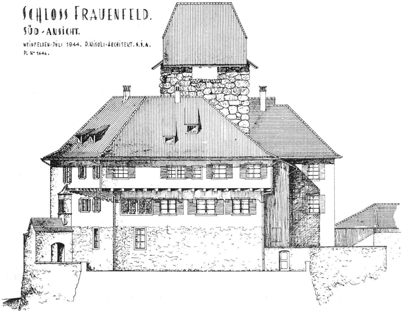
Er wurde in einer zweiten Bauetappe errichtet, also später an den Bergfried angefügt, was anhand der Baufugen und der Fundamentlage klar ersichtlich ist. Der in einer noch jüngeren Zeit aufgeführte westliche Anbau zeigt eine wenig einheitliche Struktur und dürfte mehrfach umgebaut worden sein. Ob vor der heutigen Steinkonstruktion bereits ein schlichterer, mehrheitlich in Holz errichteter Bau dort gestanden hat, werden genauere Untersuchungen ergeben.
