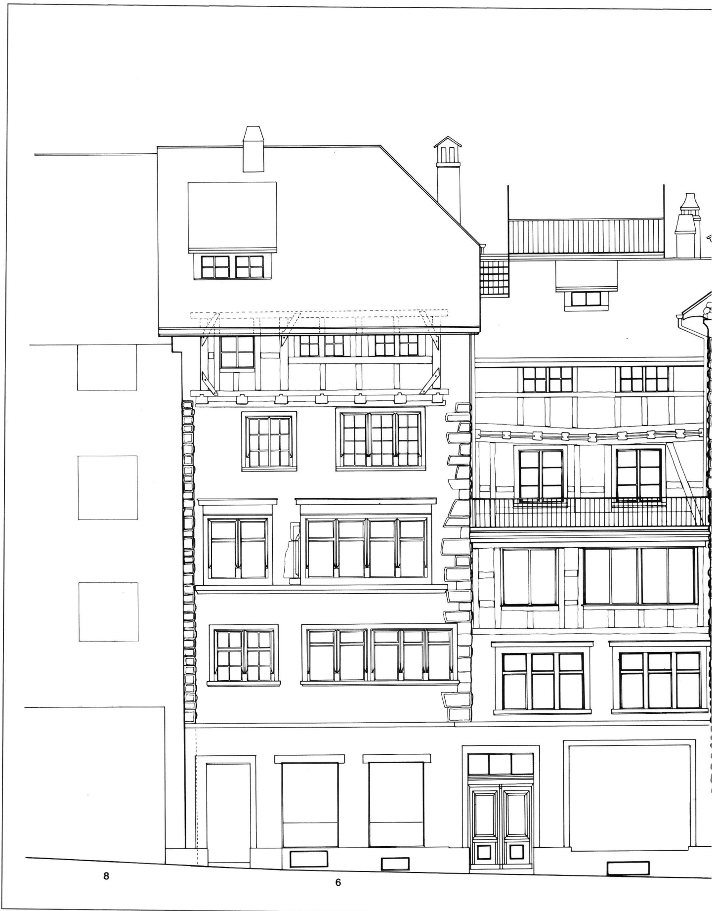
Abb. 7: Ansicht von der Rosengasse an die Nordfassaden des «Kleinen Regenbogens», des Verbindungsbaus, des «Glenterturms» und des limmatseitigen Anbaus. Massstab 1:100 (Umzeichnungen: Anita Engelhard, Zürich)
