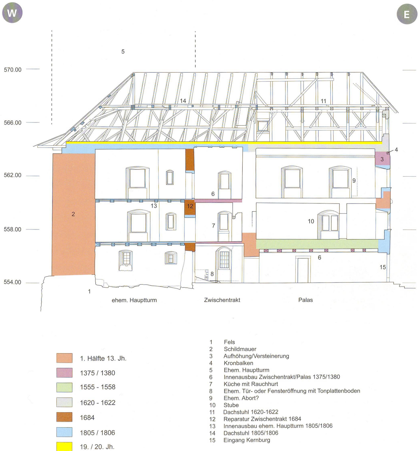
Plan 6: Brunegg AG. Schnitt W-E durch die Kernburg.
