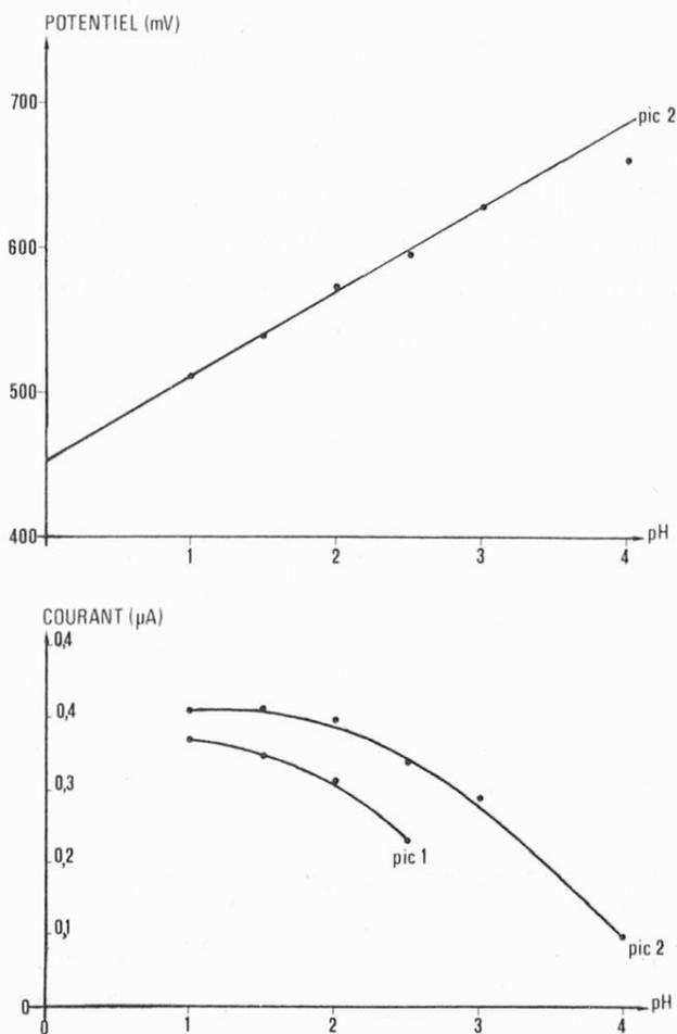
Fig. 1. Influence du pH sur le potentiel et le signal du sélénium
