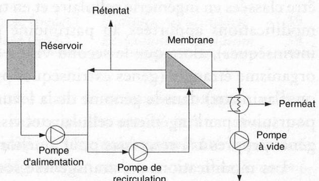
Figure 2 Principe de l'osmose inverse
