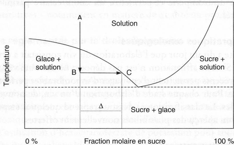
Figure 1 Principe de la cryoconcentration d'une solution de saccharose
