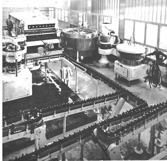
Una veduta dell'impianto della Birra Bellinzona S.A. che permette di lavare, imbottigliare, tappare, etichettare ed incassare 12.000 bottigliette all'ora.
