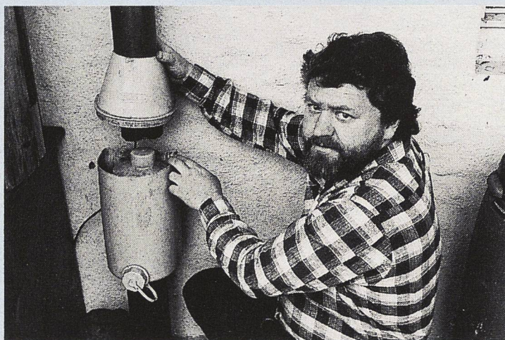
L'acqua piovana raccolta e incanalata passa attraverso un filtro a carbone
