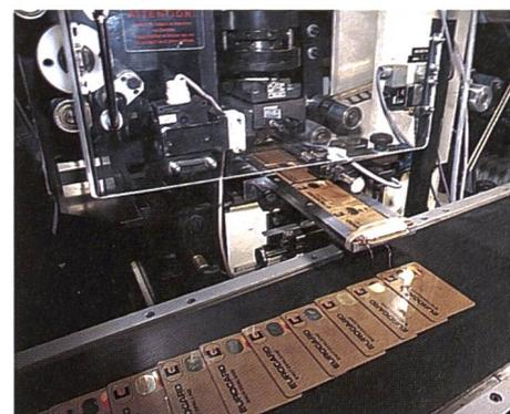
A questo punto i quattro strati sono pronti per il forno. Su una lamiera di rame vengono spinti nella pressa laminatrice, dove rimangono per periodi differenti. Per effetto della pressione e del calore, le parti si uniscono in un insieme omogeneo. Dopo il raffreddamento, il tutto viene di nuovo diviso in molte parti: nella quarta fase della lavorazione, una punzonatrice ritaglia le singole carte dal foglio di plastica.
