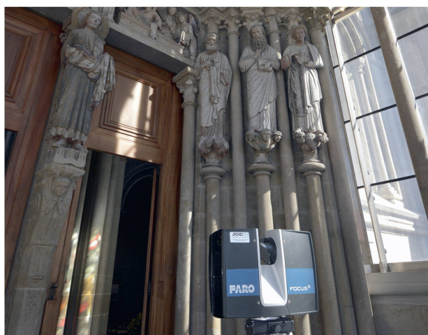
2 Le scanner Faro S350 lors de la mesure du Portail peint; l'instrument tourne à 180 degrés sur le plan horizontal et le miroir tournant projette le rayon laser sur le plan vertical à raison de 980000 mesures par seconde.
