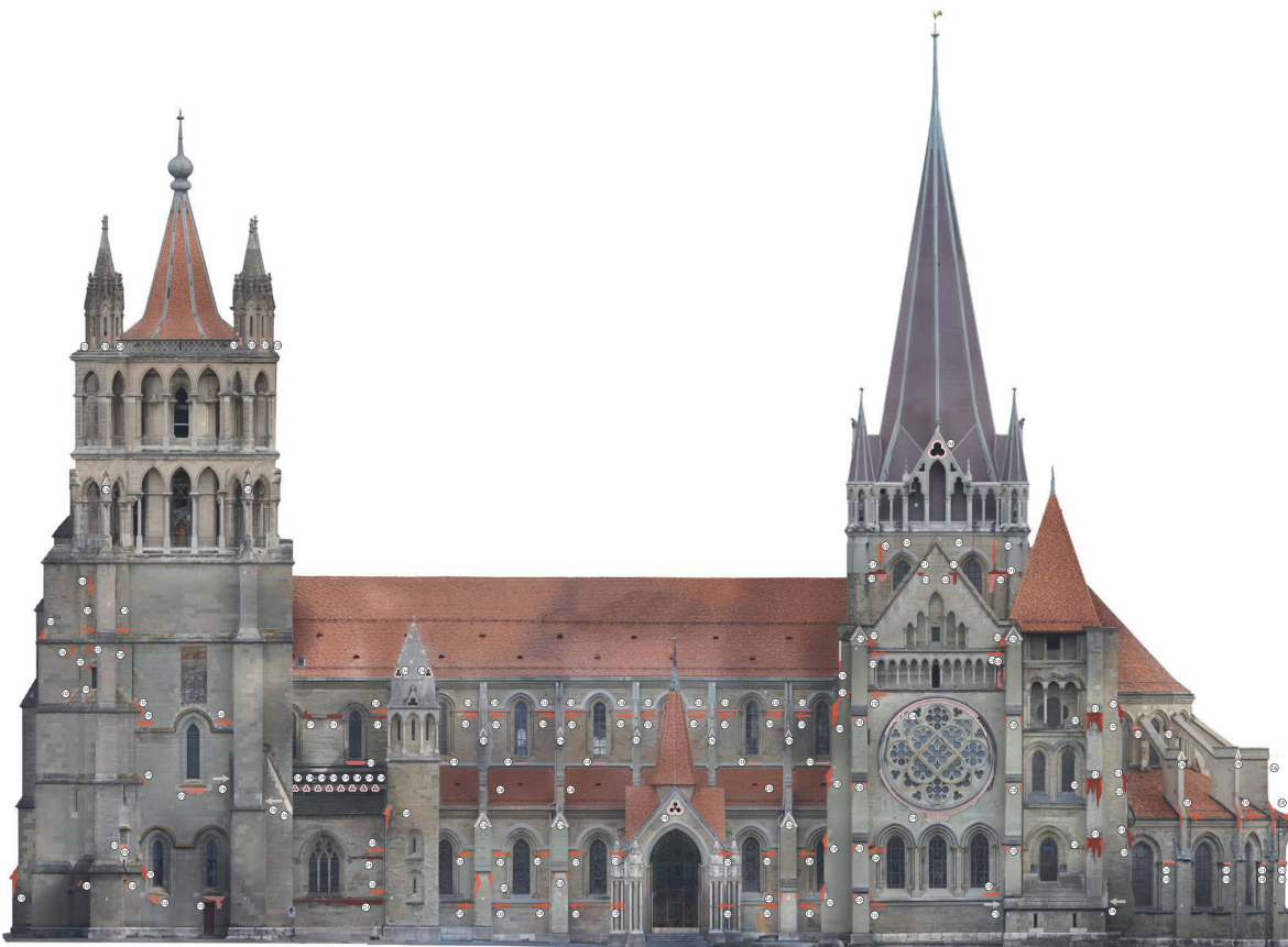
C5 Élévation sud avec inventaire des dysfonctionnements des renvois d'eau (Amstler Dom arch. sur base Archéotech, 2020).
