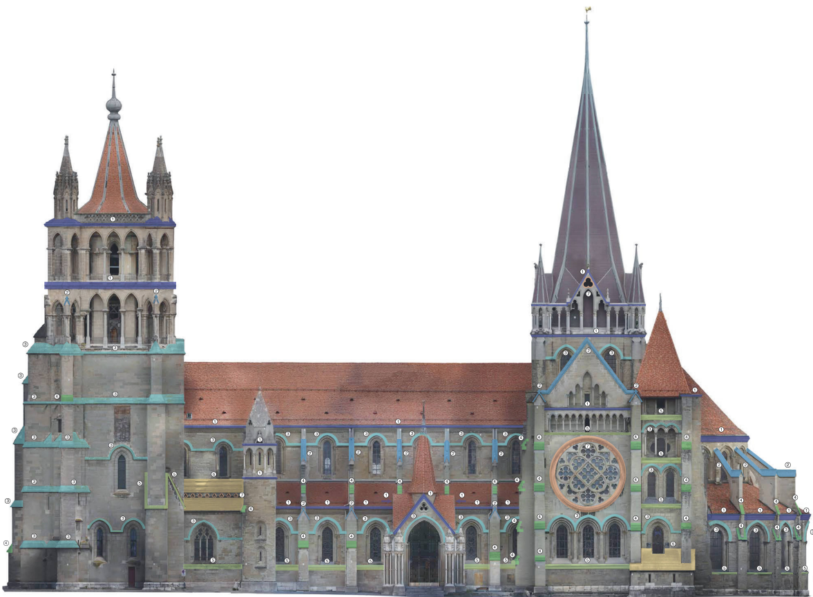
C4 Élévation sud avec inventaire des renvois d'eau (Amstler Dom arch. sur base Archéotech, 2020).
