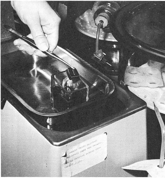
Abb. 4: Ablösen der Sporen von der Auffangschale im Ultraschallbad.
