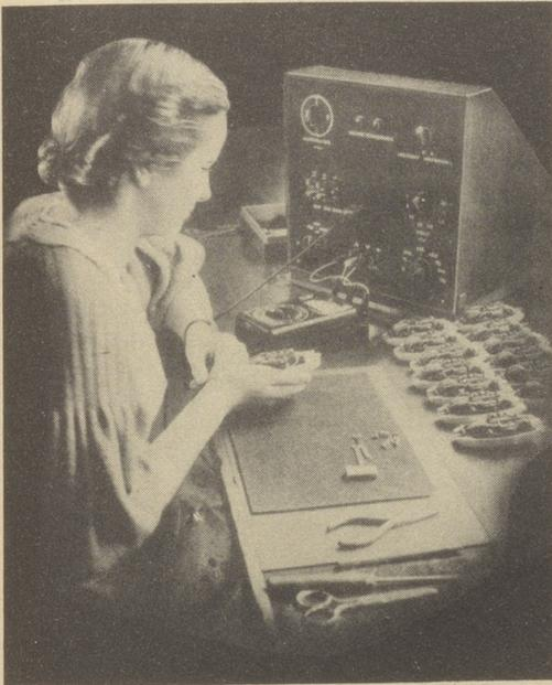
Den mit der Fabrikation beschäftigten Uhren-Arbeitern und -Arbeiterinnen liegt die Subtilität im Blut. Zur Bedienung des **Prüfstandes für die Einregulierung des Motors**, den die nebenstehende Aufnahme zeigt, eignen sich in hervorragendem Maße Frauen. Sie haben Fingerspitzengefühl und sorgen mit peinlicher Genauigkeit für schwankungslosen Lauf des Motors.
