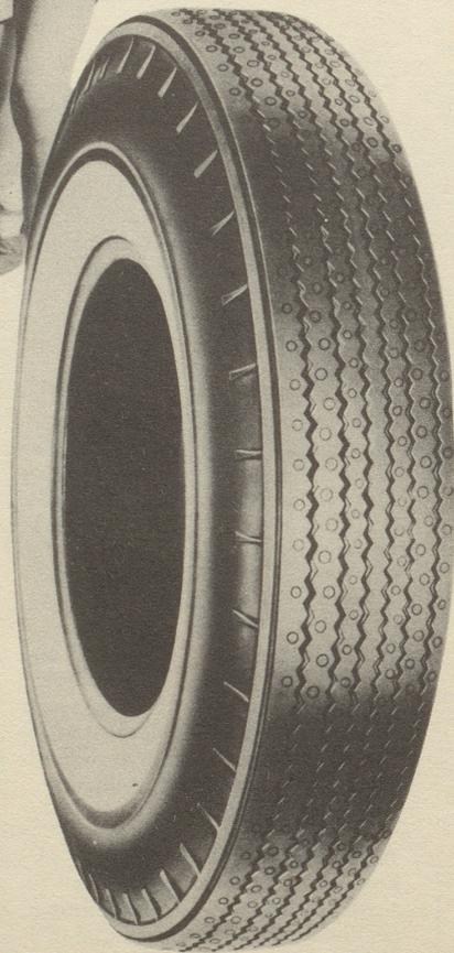
PR 12, der neue Rundschulter-Reifen von Firestone, weist in seiner Bodenberührungsfläche eine wesentlich andere Druckverteilung auf als Reifen konventioneller Bauart mit gerader Schulterpartie. Beim Abrollen bleibt das Profil praktisch offen und dadurch reduziert sich der sonst unvermeidliche Kraftverlust auf ein Minimum. Das Resultat: grössere Laufruhe, kein Schlingern und Springen; ein spursicheres Fahren ist gewährleistet.
