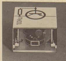
Braun Lectron ist ein Experimentiersystem, mit dem technisch interessierte Jugendliche und Erwachsene spielend die elementare und höhere Elektronik begreifen lernen. Ohne Werkzeug, ohne handwerkliches Geschick. Durch einfaches Legen von magnetischen Bausteinen. 70 verschiedene Bauelemente ermöglichen
