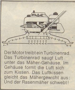
Der Motor treibt ein Turbinenrad. Das Turbinenrad saugt Luft unter das Mäher-Gehäuse. Im Gehäuse formt die Luft sich zum Kissen. Das Luftkissen gleicht das Mähergewicht aus: Und der Rasenmäher schwebt!
