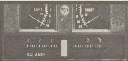
Das ist der Balanceregler, mit welchem man bei Stereobetrieb das Links-rechts-Verhältnis optimal einstellen kann.
