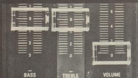
Mikrofon- und Linieneingänge bei der Aufnahme sowie Lautstärke, Höhen- und Bassregler bei der Wiedergabe werden durch Schiebepotentiometer bedient.
