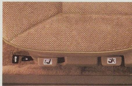
Hecktüren- und Benzintankdeckel-Entriegelung vom Fahrersitz aus. In der Höhe verstellbarer Fahrersitz. Verstellbare Rückenlehnen.
