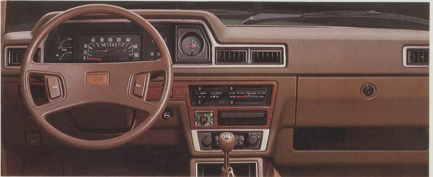
Das Design der Armaturen ist ebenso schön wie funktionell durchdacht. Alles ist leicht überschaubar und für den Fahrer in bequemer Reichweite. Kombischalter für Licht, Blinker, Scheibenwischer und Scheibendusche. Ölmanometer. Ampèremeter. Benzinwarnlicht. Fernthermometer. Tageskilometerzähler. Elektrische Quarzuhr.
