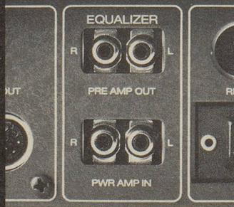
Revox bis ins Detail. Vorverstärker und Endstufe auftrennbar; ideal für Mischpult, Equalizer usw. Für Tonbandüberspielungen direkt schaltbare Kopierverbindung; davon unabhängig kann eine andere Musikquelle über die Lautsprecherboxen gehört werden. Vielfältige Klangbildregelung: 2 Filter, 3 Regler, Tone Defeat (Linearschaltung), Loudness (gehör-richtige Klangkorrektur). Aufwendige Elektronik und aufwendiges Sicherheitskonzept zum Schutz von Lautsprechern und Endstufe.
