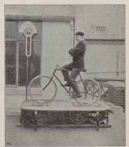
Anno 1898 stellte der Zürcher Velohändler G. Ogierkowski-Schwyzer der Presse den Gungnarel-Velo-Lernapparat vor. Ein Cyclometer zeigte automatisch die jeweilige Rollen-Fahrgeschwindigkeit in Kilometern und englischen Meilen an. Stolz zeigt uns der Fahrlehrer, dass er sein Strampelwerk bereits freiläufig beherrscht.
