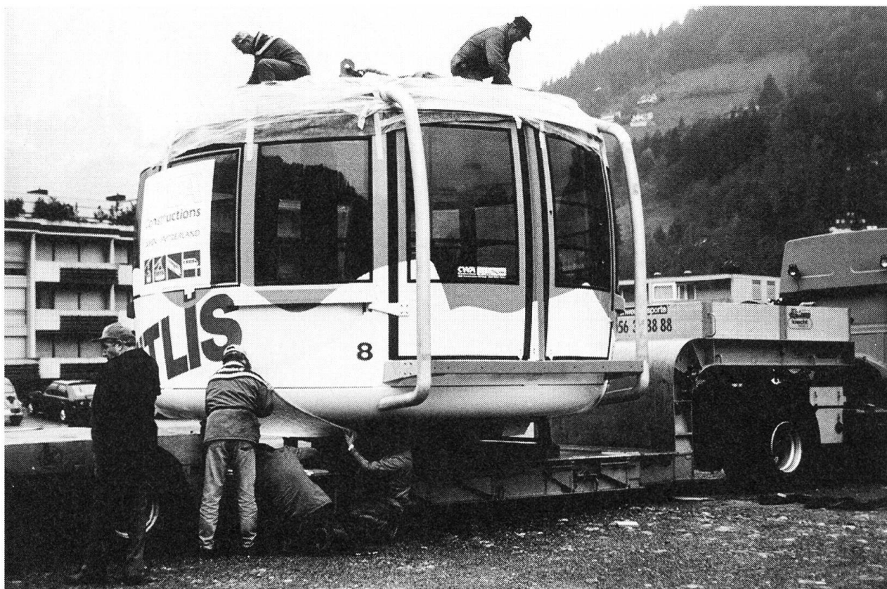
Am 3. November 1992 trafen die knapp 4 Tonnen schweren Drehkabinen in Engelberg ein, wo sie mit dem grössten Heli zum Stand geflogen wurden. (Bild: Josef Reinhard)
