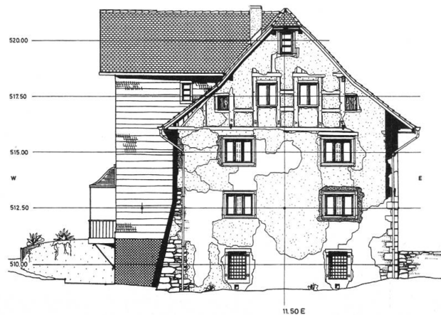
Aufnahmeplan der Südfassade.
