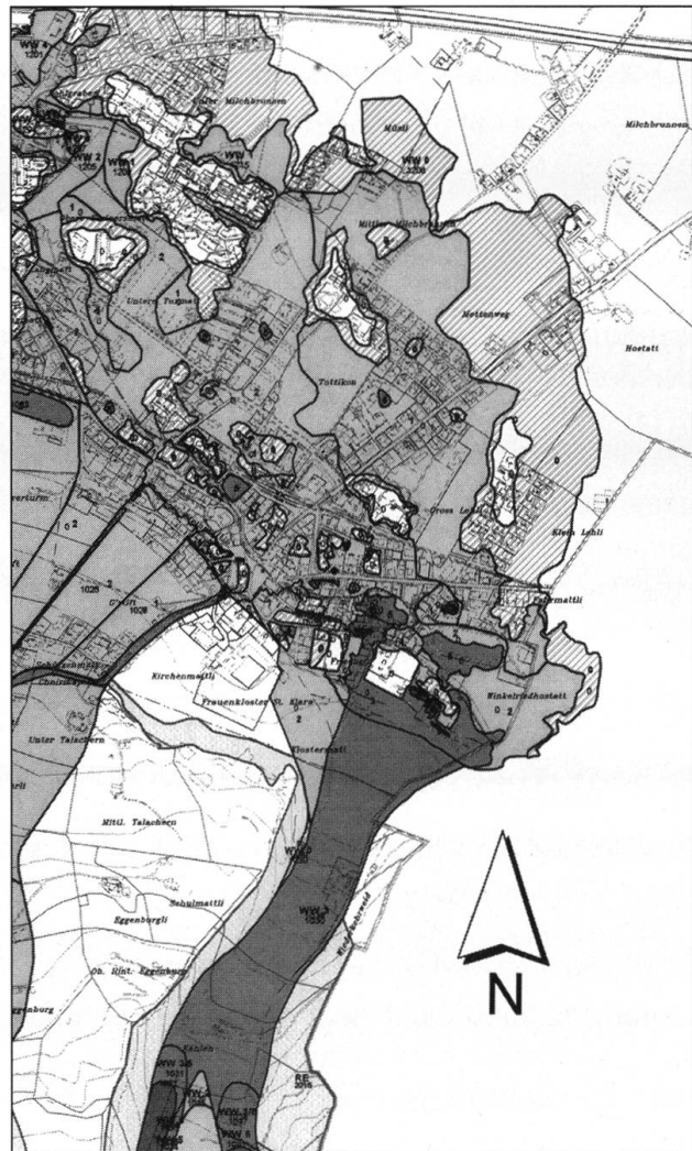
Die Gefahrenkarte gibt an, wo eine Gefährdung für Menschen und Sachwerte durch eine Naturgefahr besteht: schwarz = erheblich; dunkelgrau = mittel; grau = gering (Ausschnitt Gefahrenkarte Stans, Wildbäche).
