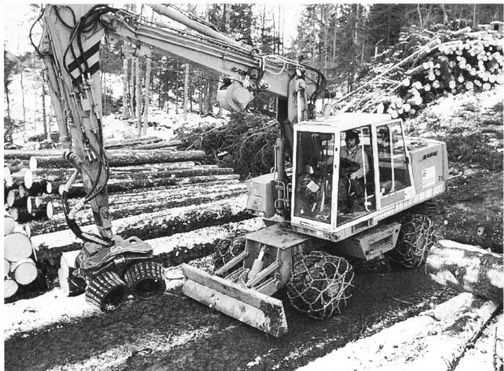
Maschinen erleichtern die schwere Waldarbeit: «Woody 60» der Korporationen Beckenried/Emmetten – Pneubagger mit Prozessor-kopf zum Entasten und Ablängen der Stämme.
