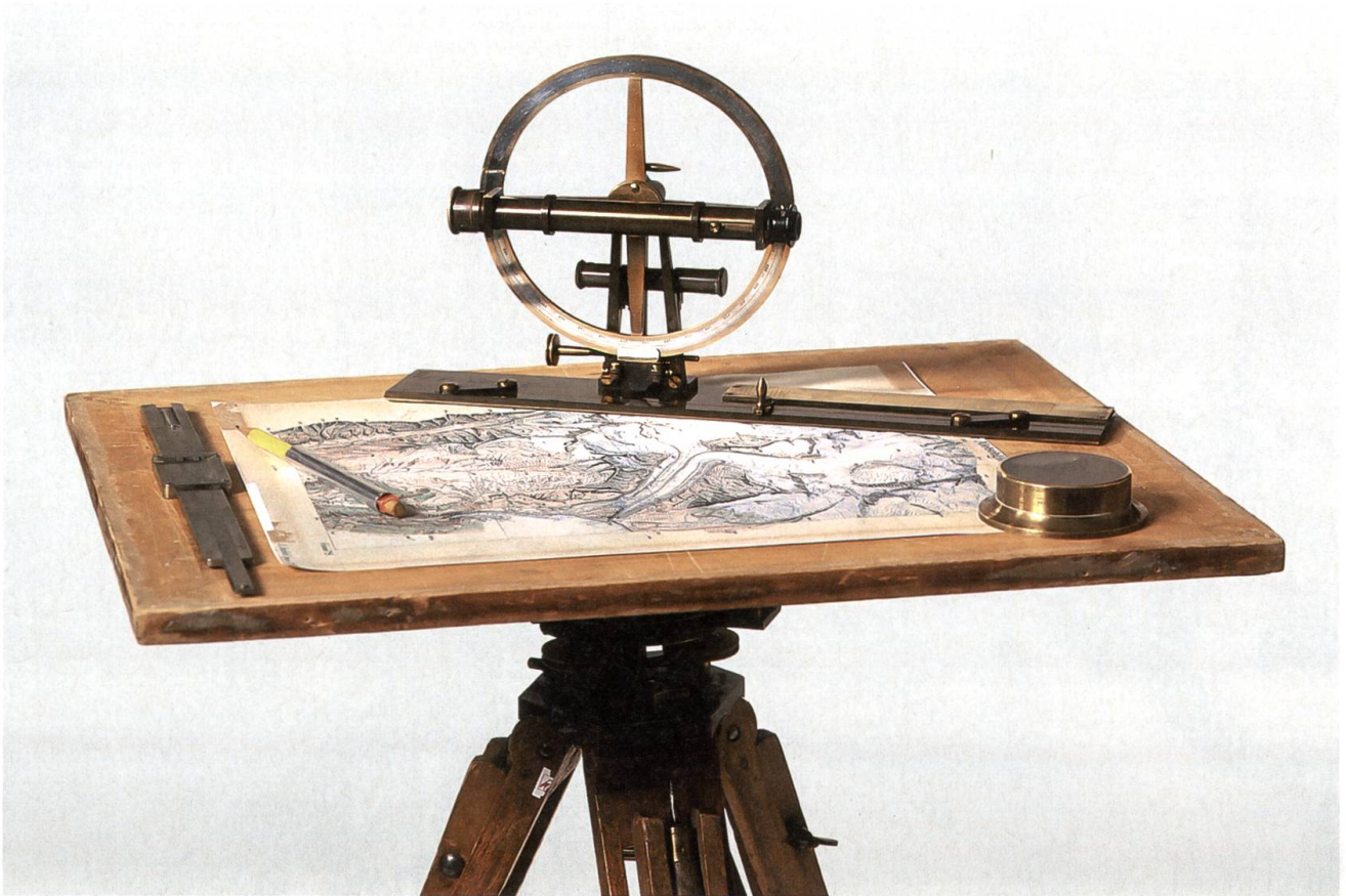
Arbeitsinstrument: Kippregel und Stativ mit umlegbaren Beinen.
