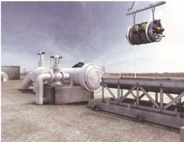
Einsatzbereiter Molch wird zur Schleuse transportiert.
